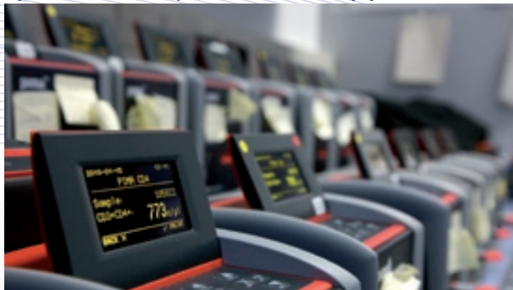
Tragbare, batteriebetriebene Pima-Analyse-Geräte sind für den vor-Ort-Einsatz geeignet – CLONDIAG GmbH
